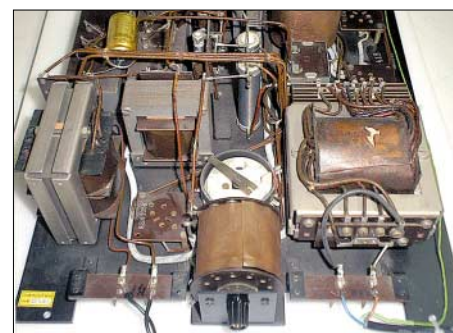
Bild 6: Vorne liegt der Drehschalter für die Gesamtlautstärke, links der Ausgangstransformator, rechts der Netztransformator, dahinter der Entbrummer
