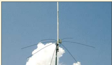
Das Besondere an der Vertikalantenne von ECO Antenne aus Italien sind kurze dünne Drähte am Fußpunkt, die nicht als „echte“ Radials fungieren, sondern mit dem Erdboden einen Kondensator bilden. Der Beitrag beleuchtet den theoretischen Hintergrund und untersucht die Leistungsfähigkeit in der Praxis.
