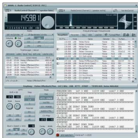
Bild 3: Das Menü RadioControl ist das Kontrollzentrum. Hier lassen sich Stationsdaten aus einer Liste abrufen oder Empfangsparameter manuell einstellen.
