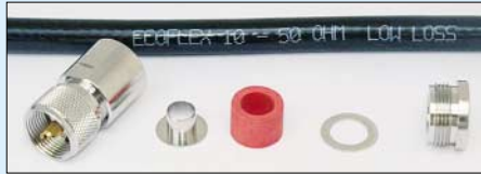
Bild 4: Jeder Steckertyp lässt sich nur für ein bestimmtes Kabel nutzen; hier für Ecoflex 10.
