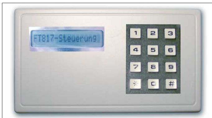
Bild 1: Die externe Steuerung lässt sich in Reichweite des Mikrofons oder der Morsetaste postieren und ermöglicht so die schnelle Frequenzeingabe und den VFO-Wechsel am Yaesu FT-817.
