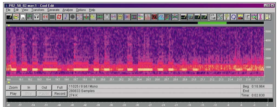
X-Achse: Zeit in Sekunden mit Signal VDL und je zwei schwachen Dits; Echo aus dem Dit bei t = 20,02 s erkennbar bei t = 20,16 s. Y-Achse: NF-Bandbreite mit Intermodulations-, „Flammen“ Quelle: DL1VDL
