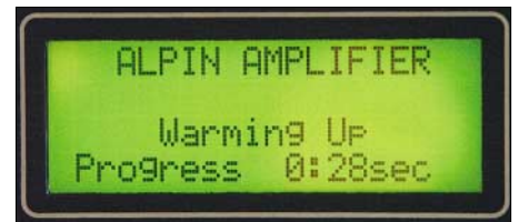
Bild 3: Der Countdown läuft – die Alpin 100 schützt die Röhre nach dem Einschalten.
