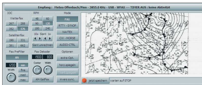
Bild 6: Der Faxdecoder lässt sich für alle gängigen Übertragungsformate optimieren.
