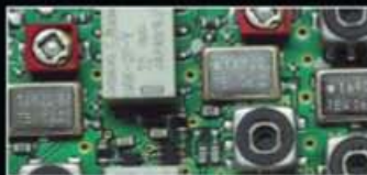
1. ZF: Drei Roofing-Filter bei 69,45 MHz
